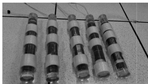
图 7 感应式磁传感器磁棒
