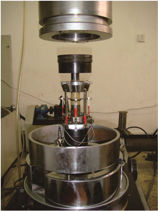
图 1 三轴高压釜 Fig. 1 The triaxial press cell
