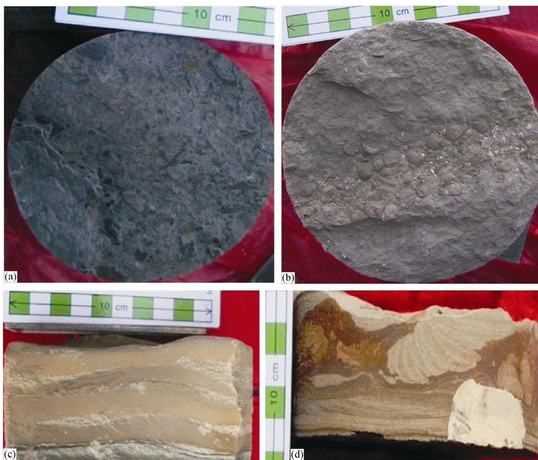
(a) 大 154 井嫩江组半深湖黑色泥岩(1604.5 m); (b) 葡 311 井嫩江组叶肢介生物化石(470.1 m); (c) 大 154 井嫩江组粉砂岩波状层理(1128 m); (d) 放 2 井嫩江组粉砂岩生物遗迹(1159 m)
